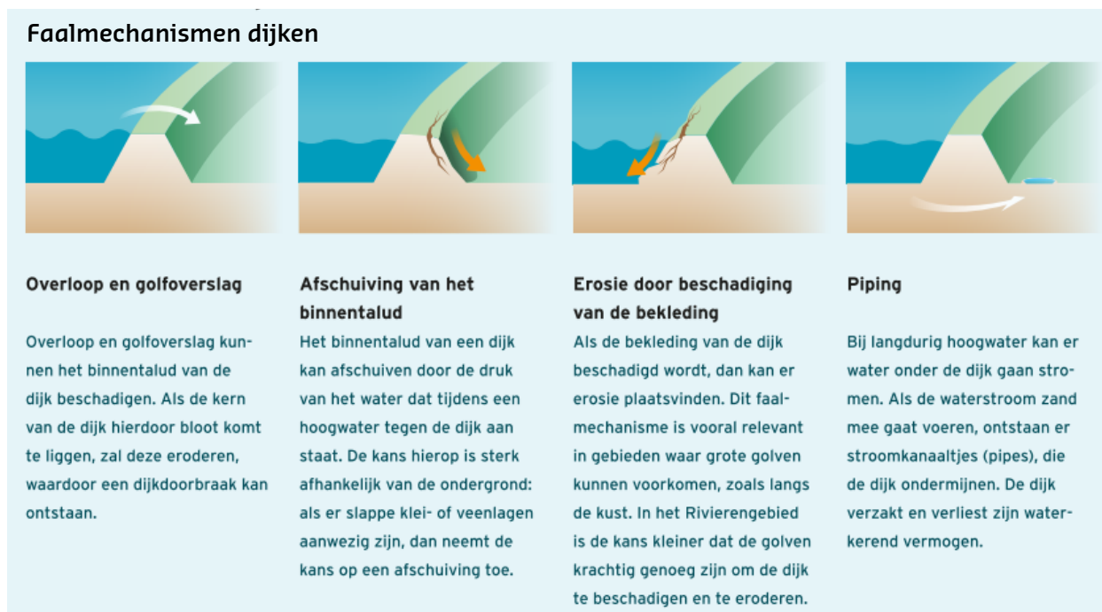
Figuur 4.3 Schematische beeld van enkele belangrijke faalmechanismen van dijken (bron: VNK)
