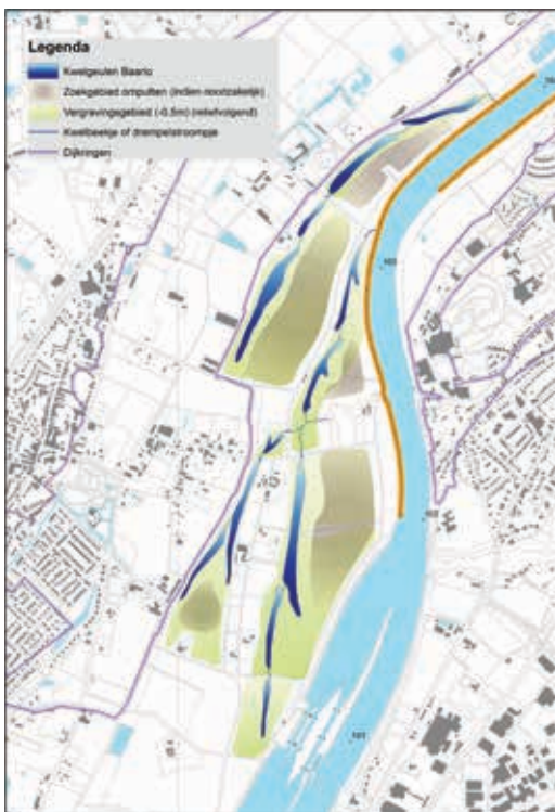
Schetsontwerp voor de aanleg van kwelgeulen in de Weerd bij Baarlo.
