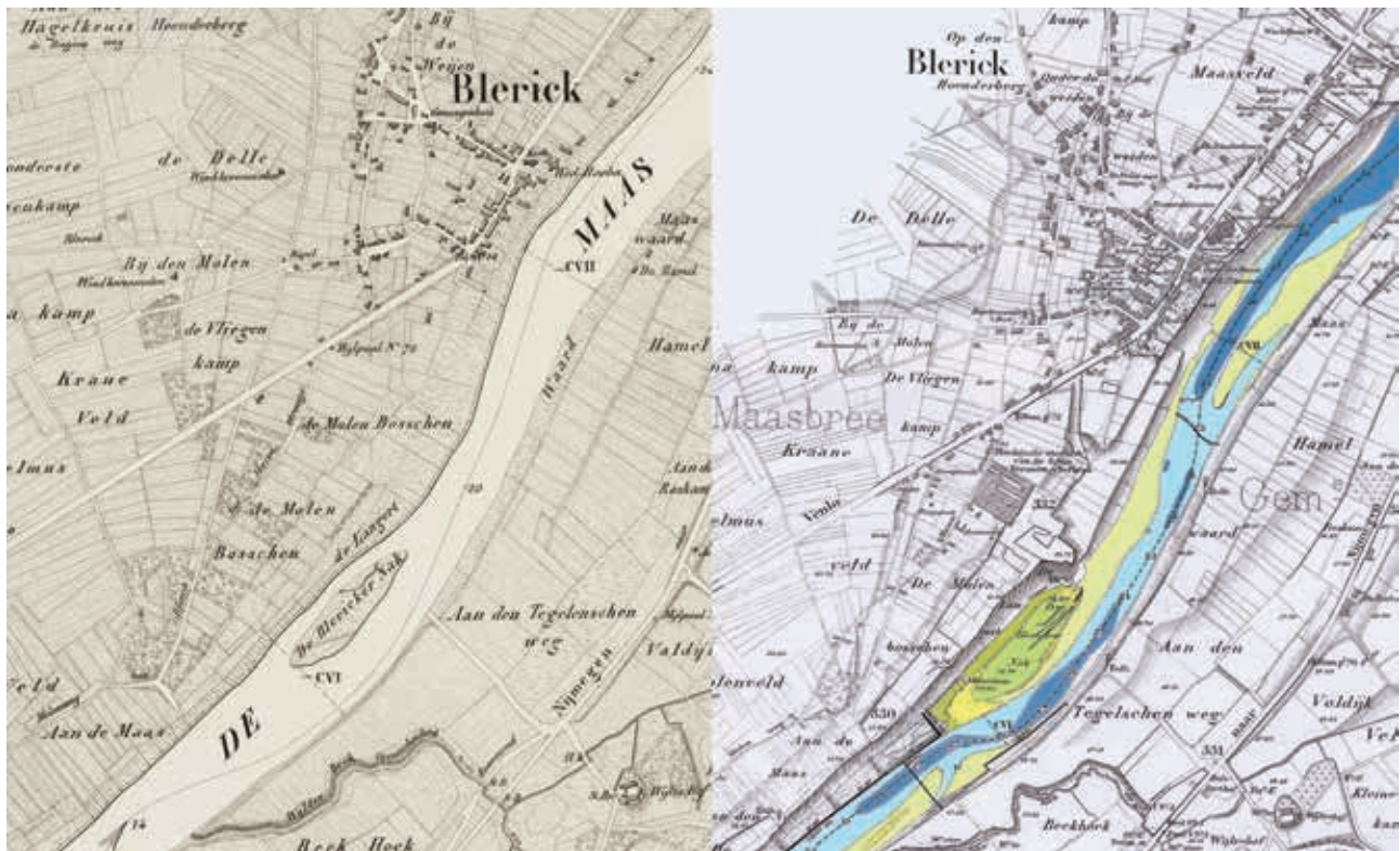
De 'aanwinning' van het eiland 'De Blericker Nak' in de Maas bij Venlo, gedurende kanalisatiewerken halverwege de 19 e eeuw.
