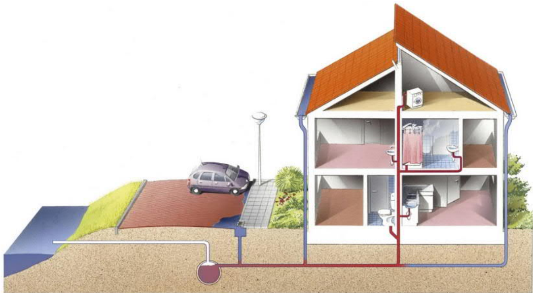
Figuur 3-1: Gemengde riolering ( https://www.riool.info/soorten-riolering )
